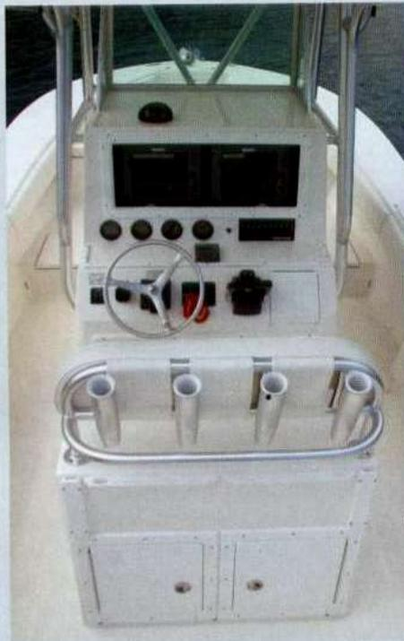
Sopra, la postazione di comando è ben protetta dal parabrezza. Alle spalle del divanetto, la batteria portacanne.
